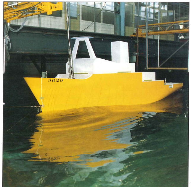
Essais techniques avec une maquette du futur Belgica
